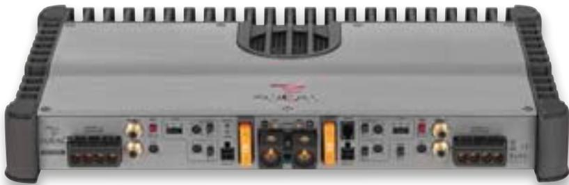
Усилитель смонтирован в литом алюминиевом корпусе. С трёх сторон — Т-образные рёбра охлаждения, четвёртая сторона и верхняя крышка — из алюминиевых профилей «под титан». В середине — вентилятор охлаждения с управлением от термодатчика и подсвеченный логотип.
